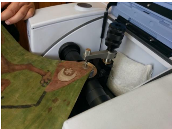
Директно изследване на обект чрез отражателна (ATR) техника на анализ
